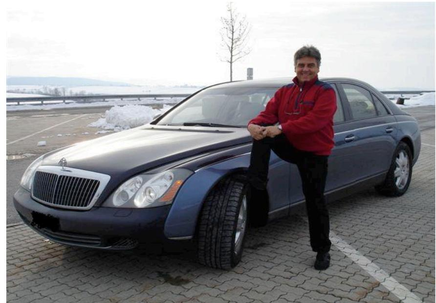
Seit 2002 wird der Maybach bei Daimler in Stuttgart in alter Tradition hauptsächlich handgefertigt, nach den Wünschen des Kunden hergestellt. Biturbo 12 Z. Motor 5980 ccm Hubraum, mit 450kW/612 PS, Nenndrehmoment 1000Nm bei 2000-4000/min, Länge 6.165 mm, Breite 1.980mm, Zulässiges GG 3.260kg, Preis ab 550'000.- Euro, Treibstoffverbrauch Autobahn 12.4 Liter->EcoDrive!
